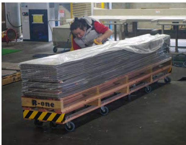
専用パレットへ施工順に積み上げた後に梱包する
