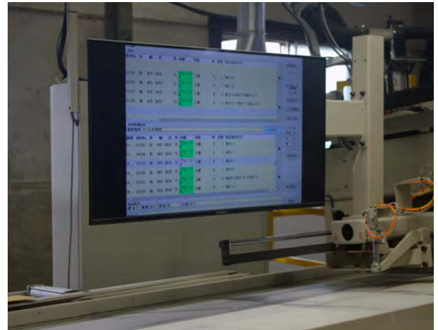
加工機の操作盤と取出し口の大型モニターでサイディングの形状や番付、梱包順などをチェックする
