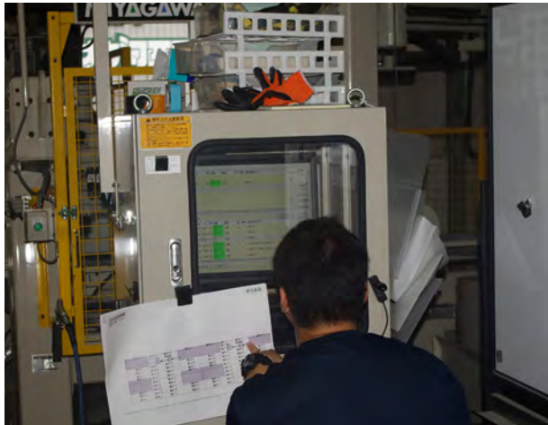
加工機の操作盤と取出し口の大型モニターでサイディングの形状や番付、梱包順などをチェックする
