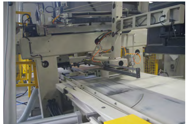
サイディングの切断・欠き加工を自動で行う
